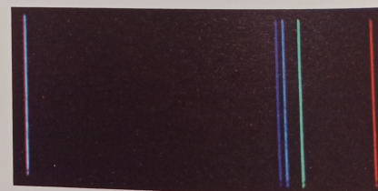
c) Ordre 1 du spectre du cadmium avec un réseau plus dispersif à 300 traits/mm. Le spectre est composé de quatre raies principales : violette, bleu, vert et rouge. Avec un réseau moins dispersif à 80 traits/mm, les raies violette et bleu sont tout juste séparées.
